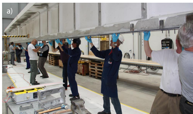
Rys. 7. Wzmocnienie dźwigara: a) na zginanie; b) na ścinanie
