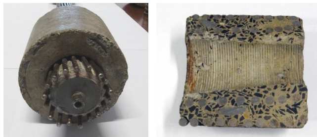
Rys. 2. Widok i przekrój zakotwienia z betonu (żelbetu)
