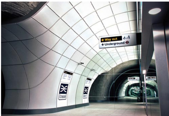
Rys. 9. Wydrukowana techniką druku 3D makieta w skali 1:1 peronu stacji Crossrail [9]
