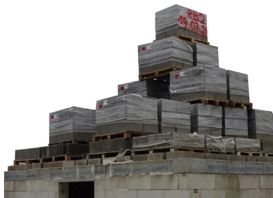
Rys. 9. Widok modelu pod maksymalnym obciążeniem – próba zniszczenia
