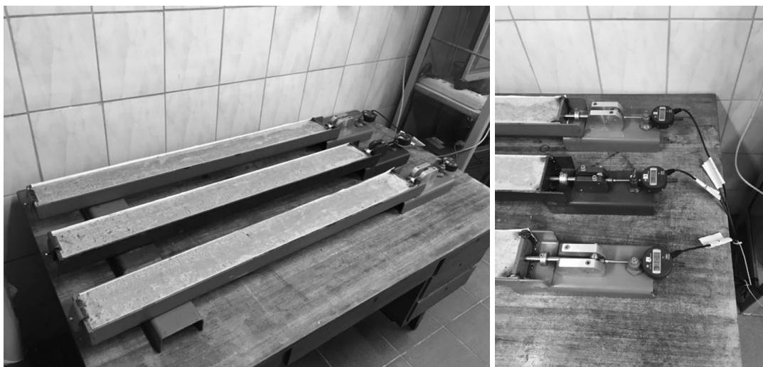
Rys. 3. Rynny skurczowe z zamontowanymi czujnikami przemieszczeń rejestrującymi zmiany długości próbek
