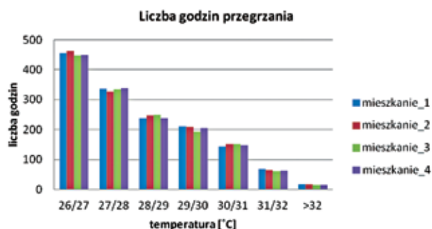
Rys. 6. Liczba godzin przegrzania w budynku po termomodernizacji z zastosowaniem zacięń – mieszkania piętro siódme
