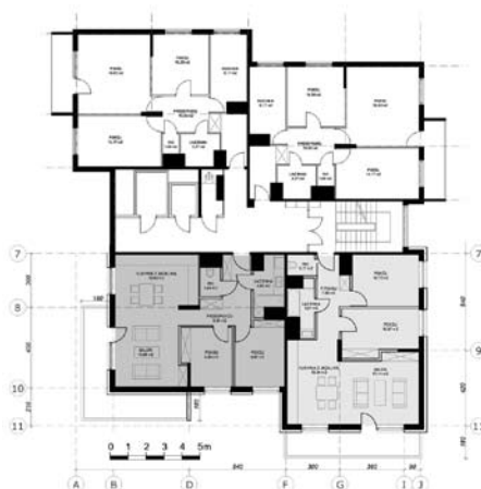
Rys. 7. Rzut kondygnacji powtarzalnej budynku typu punktowiec – sytuacja obecna, górą rysunku (dokumentacja [3]); propozycja rewitalizacji wariant: II-65 m 2 , dół rysunku (opracowanie zespołu)
