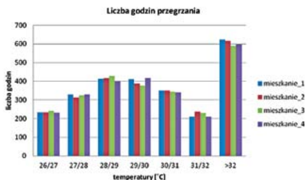
Rys. 5. Liczba godzin przegrzania w budynku po termomodernizacji – mieszkania piętro siódme
