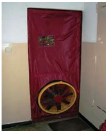
Rys. 1. Zestaw drzwi nawiewnych Blowerdoor z kontrolerem Retrotec 3000 w lokalu 1
