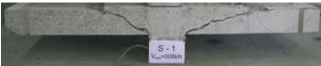
Rys. 2. Przekrój przez płytę modelu S-1 z widokiem rys ukośnych
