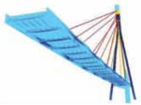
Rys. 15. Kładka nad ul. Wołoską zaprojektowana przez Transprojekt Gdańsk; modele numeryczne MES SOFiStiK
