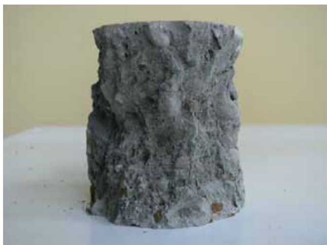
Rys. 12. Próbką betonu po wykonaniu badania wytrzymałości na ściskanie
