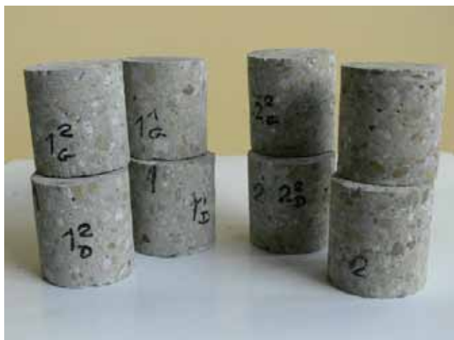
Rys. 11. Sformatowane próbki betonu pobrane z fundamentów, przygotowane do badań wytrzymałości na ściskanie
