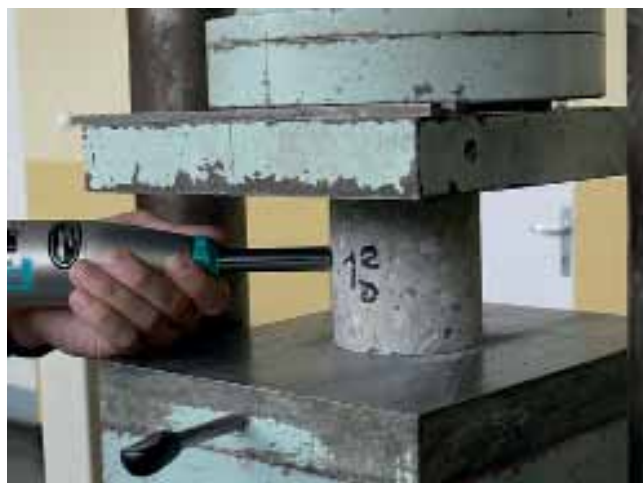
Rys. 14. Pomiar liczby odbicia podczas badania wytrzymałości na ściskanie
