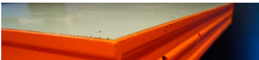
Rys. 9. Poszycie - tworzywo polipropylenowe zbrojone z blachą aluminiową
