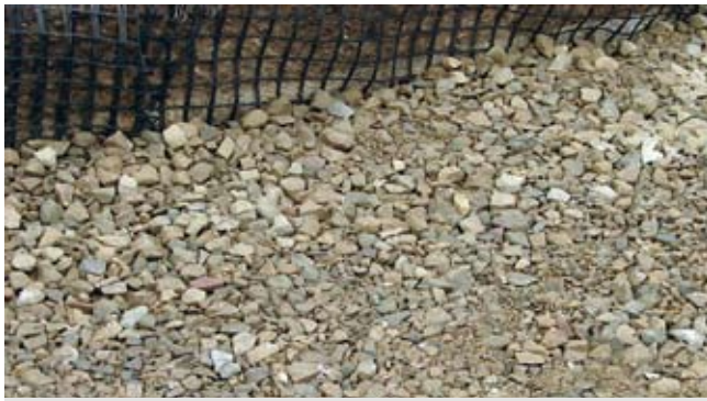
Rys. 3. Kruszywo „kruszone” pozyskiwane z materiału miejscowego regionu Warmii i Mazur. Widoczne różnicowanie petrograficzne (źródło własne)
