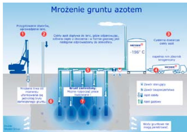
Rys. 9. Technologia mrożenia gruntu azotem (źródło: Messer)
