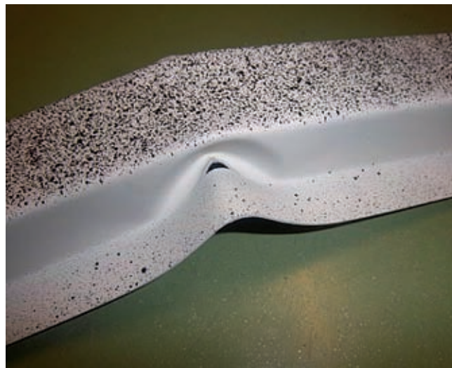
Rys. 5. Stan deformacji próbki
