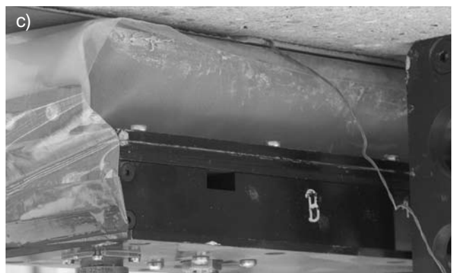
Rys. 9. Bezkotwowy system naprężania ze stopniową redukcją siły naciągu w taśmie: a) schemat naprężania taśmy FRP, b) system nagrzewania taśmy, c) widok poduszki dociskowej [25]
