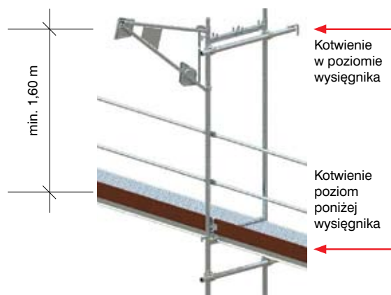
Rys. 4. Kotwienie rusztowania w miejscu zamocowania wysięgnika wciągarki
