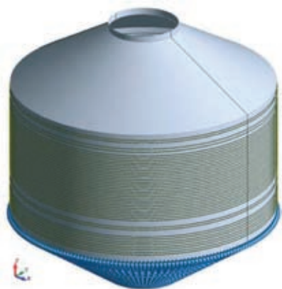
Rys. 5. Zastępcze obciążenie liniowe od sprężenia
