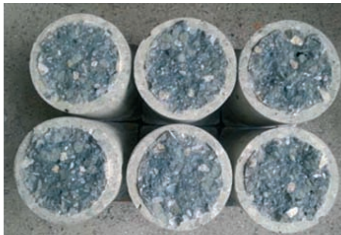
Rys. 4. Badanie wytrzymałości betonu na osiowe rozciąganie (z lewej), przelom próbek (z prawej)
