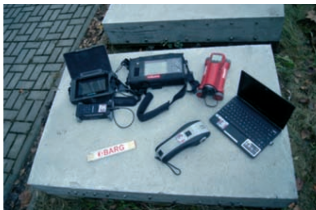
Rys. 3. Rejestrujące urządzenia badawcze (skanery zbrojenia)
