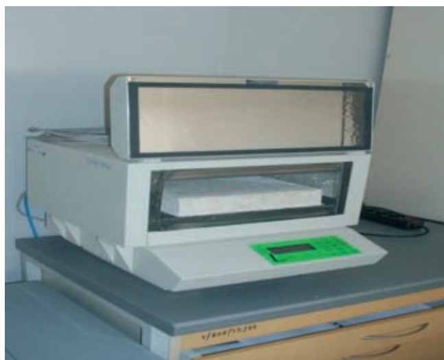
Rys. 9. Próbka umieszczona w płytowym aparacie Bocka
