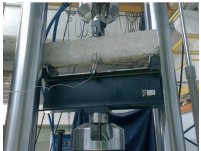
Rys. 2. Beleczka betonowa na stanowisku badawczym
