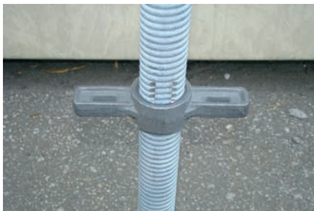
Fot. 1. Przykład zabezpieczenia podstawki śrubowej przed maksymalnym wykręceniem nakrętki
