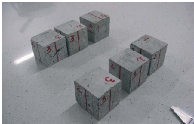
Fot. 2. Próbkę przed badaniem ścieralności – próbki z betonu na kruszywie ceramicznym (numer 4÷6) oraz próbki na kruszywie żwirowym (numer 1÷3)
