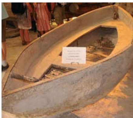
Rys. 9. Żelazobetonowa łódź zbudowana przez J. Lambota [15]
