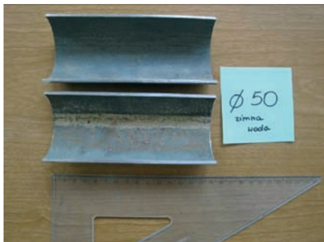
Rys. 1. Wżery w rurach transportujących zimną wodę
