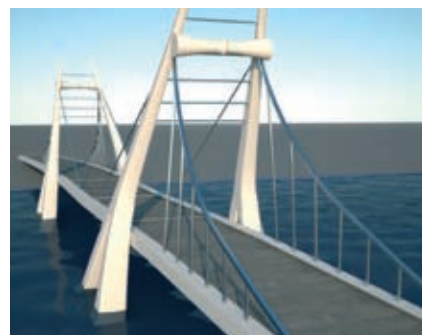
Rys. 5. Most zwodzony, wariant I, widok z przycółka, stan opuszczony
