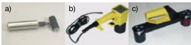
Rys. 4. Wykorzystywane w metodzie IE przetworniki piezoelektryczne
