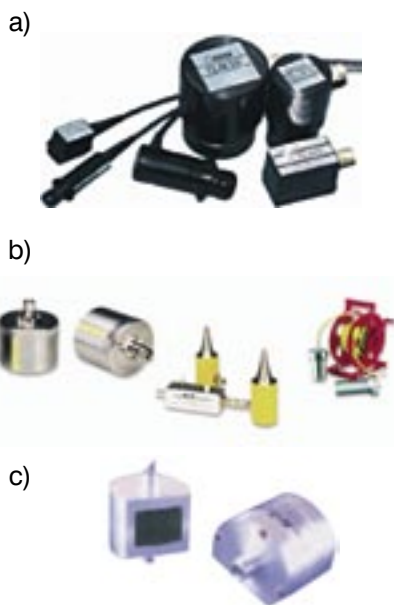
Rys. 7. Przykłady współpracujących z betonoskopami głowic: a) walcowych [M-1], b) z koncentratorami [M-2], c) rolkowych [M-2]
